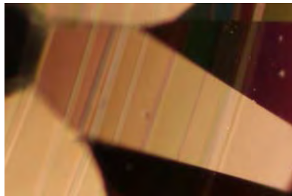
รูปที่ 4.2.4 มลทินแถบการเจริญเติบโตของผลึก ของพลอยแซปไฟร์ที่ผ่านการปรับปรุงคุณภาพ 50x (SVT21)
