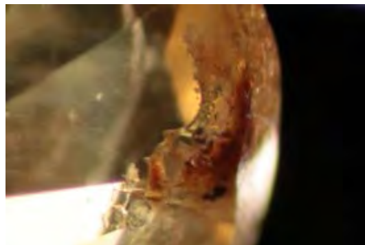
รูปที่ 4.2.13 มลทินผลึกแร่หลอมละลาย ของพลอยแซปไฟร์ที่ผ่านการปรับปรุงคุณภาพ 50x (SVT2)
