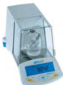
รูปที่ 3.2.1 เครื่อง Hydrostatic Balance และน้ำยาจากสถาบันวิจัยและพัฒนาอัญมณี และเครื่องประดับแห่งชาติ (องค์การมหาชน)
