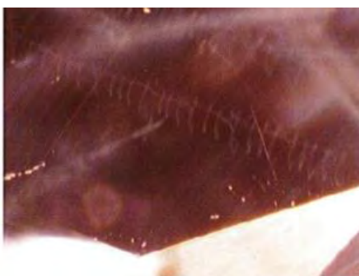
รูปที่ 2.1.5 แสดงลักษณะมลทินที่มีลักษณะเรียงตัวกันคล้ายตะขาบ ของพลอยที่ผ่านการเผาด้วยความร้อนสูง (GIT ISSUE 1/2009)
