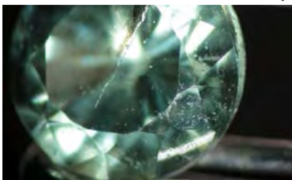
รูปที่ 4.2.1 รอยแตกบริเวณผิวพลอย ของพลอยแซปไฟร์สีเขียวอมเหลืองธรรมชาติ 40x (NH9)
