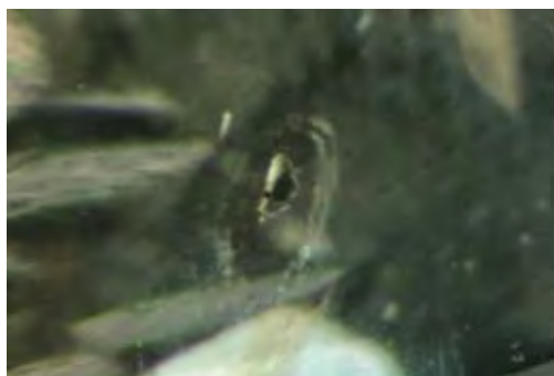
รูปที่ 4.2.9 มลทินผลึกแร่ ที่มีมลทินผลึกแร่ซ่อนอยู่ภายใน ของพลอยแซปไฟร์สีเขียวอมเหลืองธรรมชาติ 50x (NH5)
