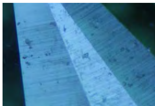
รูปที่ 4.2.2 มลทินแถบการเจริญเติบโตของผลึก ของพลอยแซปไฟร์สีเขียวอมเหลืองธรรมชาติ 50x (NH8)
