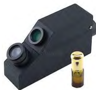
รูปที่ 3.2.2 เครื่อง Refractometer และน้ำยาจากสถาบันวิจัยและพัฒนาอัญมณีและเครื่องประดับแห่งชาติ (องค์การมหาชน)
