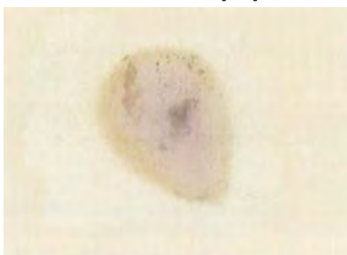
รูปที่ 2.1.1 แสดงลักษณะขอบพลอยสีเหลืองของพลอยแซฟไฟร์สีชมพูที่ผ่านการเผาพร้อมกับสารเบริลเลียม (GIT ISSUE 1/2009)
