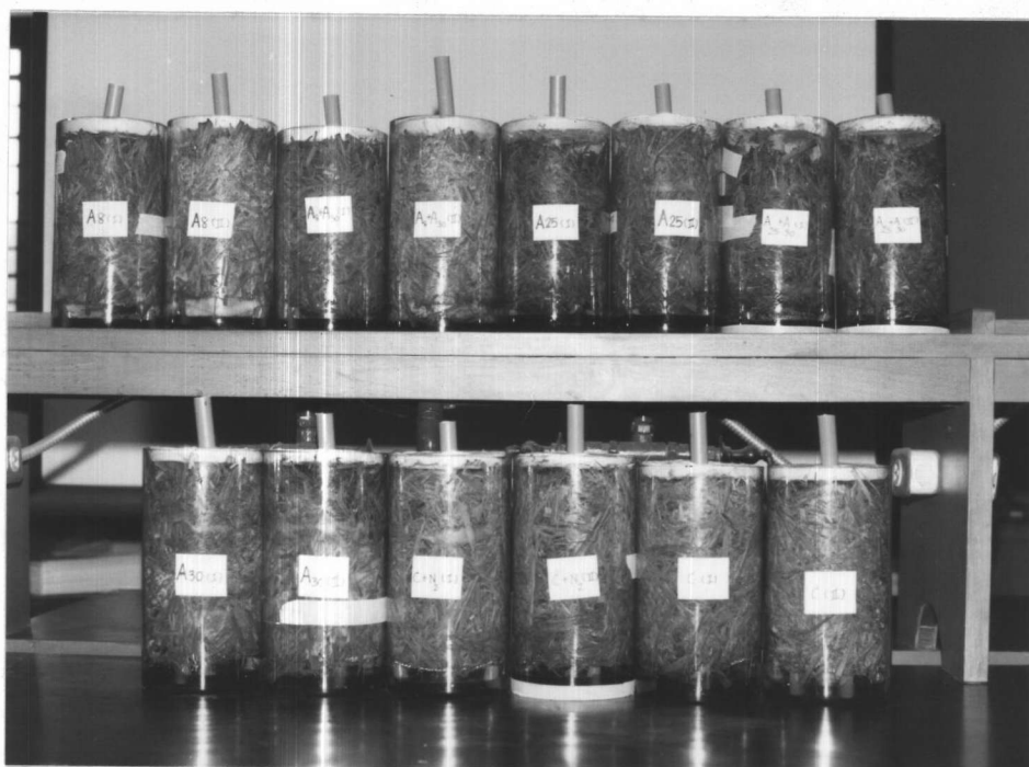
รูปที่ 4.69 แสดงการหมักฟางข้าวในโหลหมัก โดยมีท่อเอสลอนสำหรับระบายอากาศ บ่มไว้ที่อุณหภูมิห้อง (ประมาณ 30 ถึง 32 องศาเซลเซียส)
