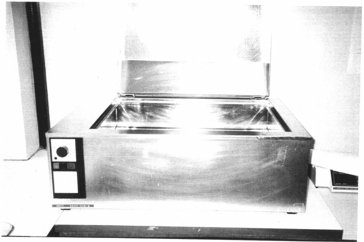
รูปที่ ๗.7 แสดงรูปของอ่างน้ำร้อน (Water Bath)
