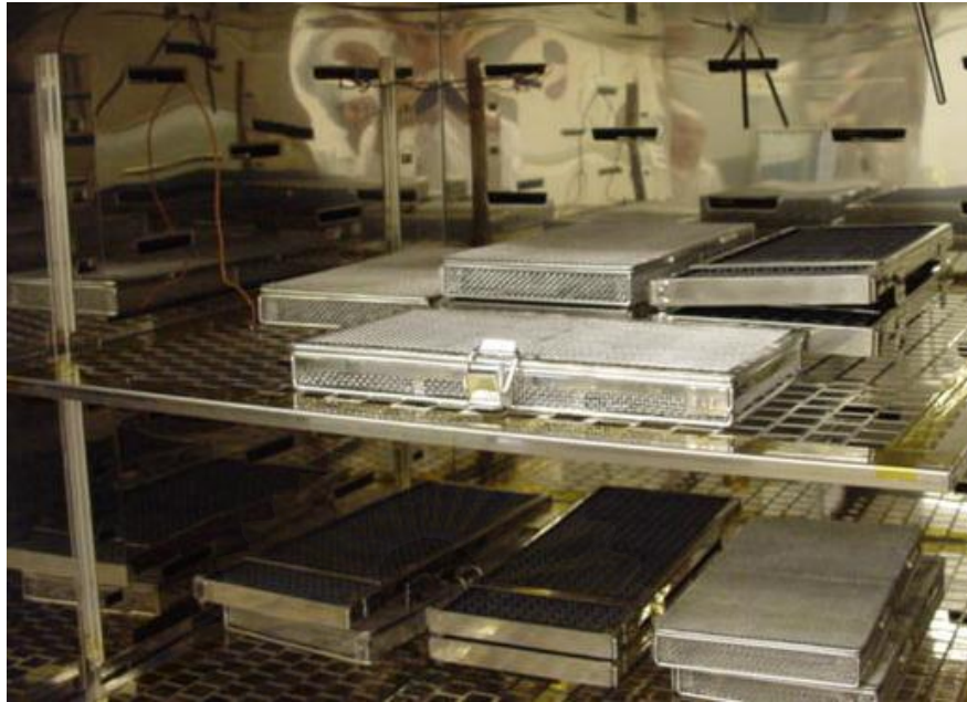
รูปที่ 3.5 ภายในเครื่องทดสอบการคงอยู่ของข้อมูล (Data Retention)
