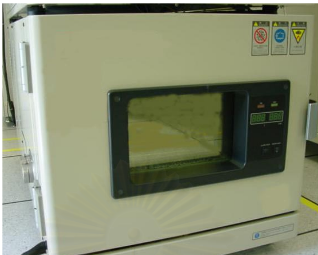
รูปที่ 3.13 การทดสอบอุณหภูมิ-ความชื้น(Temperature - Humidity Bias)
