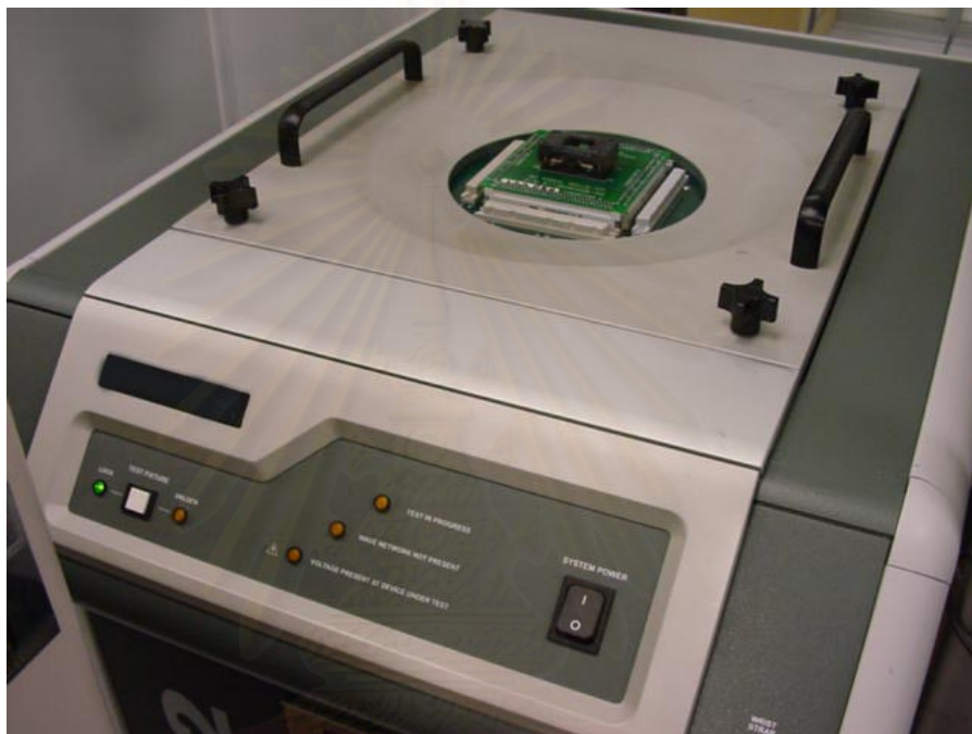
รูปที่ 3.8 เครื่องทดสอบความไวต่อการคายประจุไฟฟ้าสถิตกับแบบจำลองเชิงร่างกายมนุษย์ ซึ่งมีช็อกเกิดสำหรับใส่ไอซี
