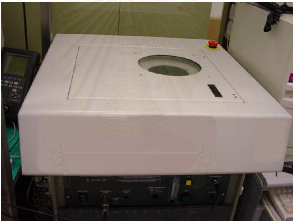
รูปที่ 3.9 เครื่องทดสอบความไวต่อการคายประจุไฟฟ้าสถิตกับแบบจำลองเชิงอุปกรณ์อิเล็กทรอนิกส์
