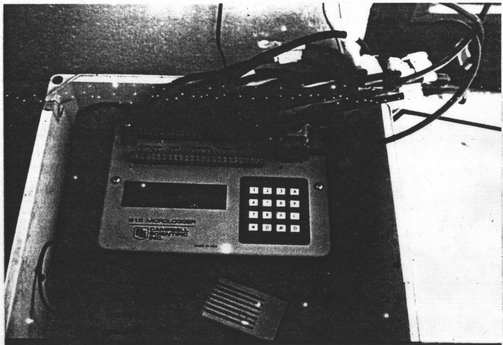
รูปที่ 6 ลักษณะ เครื่องมือที่ใช้วัดอุณหภูมิ เรียกว่า MICROLOGGER
