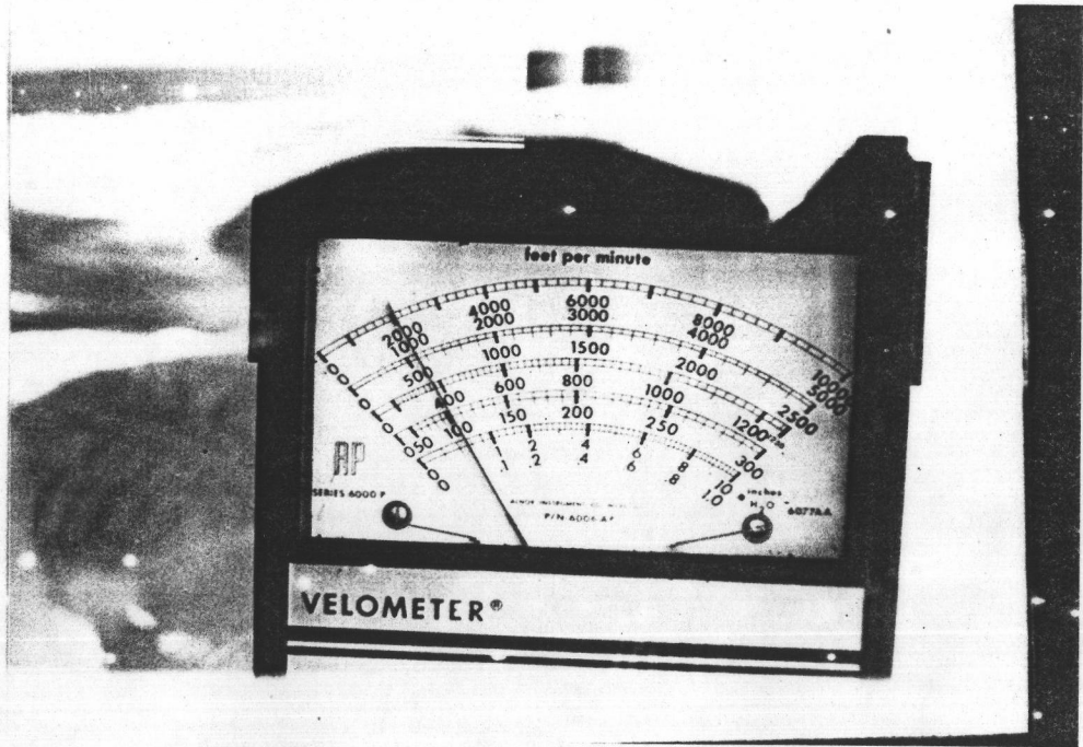
รูปที่ 8. เครื่องวัดความเร็วลมในท่อ
