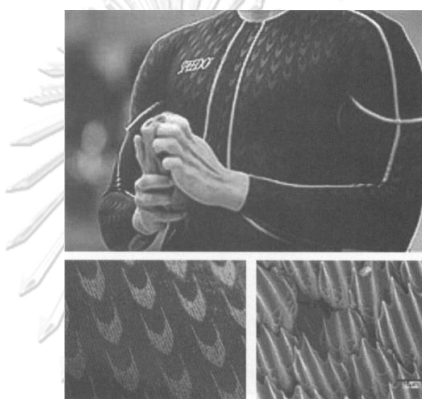
ภาพที่ 5 แสดงพื้นผิวของเนื้อผ้าจะพิมพ์ลายด้วยซิลิโคนทำให้เกิดลายนูนเป็นรูปตัววี
