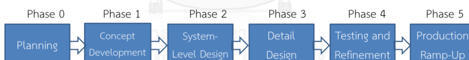
ภาพ 1 ขั้นตอนในกระบวนการพัฒนาผลิตภัณฑ์ตามแนวของ Ulrich and Eppinger
