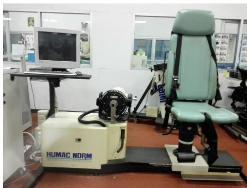
ภาพที่ 7 เครื่องทดสอบความแข็งแรงไอโซโคเนติกยี่ห้อ Humac Norm
