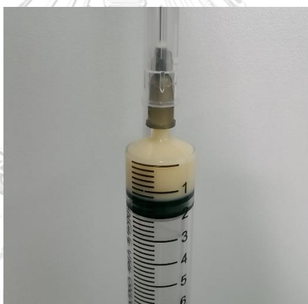
ภาพที่ 4.22 ลักษณะสารแขวนลอยตั้งต้นสำหรับการเตรียมเส้นใย Pt-HA ที่เตรียมจากสภาวะที่ 3.1
