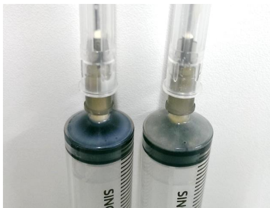
ภาพที่ 4.34 สารตกค้างในหลอดฉีดสารหลังการเตรียมเส้นใยด้วยเทคนิคอิเล็กโตรสปินนิง โดยใช้สารตั้งต้นที่ผ่านการกระจายสารเป็นเวลา 45 นาที (ซ้าย) และ 60 นาที (ขวา)
