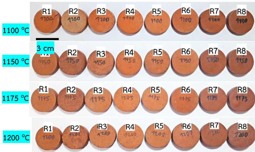
รูปที่ 4.32 ชิ้นงานดินเหนียวราชบุรีหลังผ่านการเผาที่อุณหภูมิ 1100, 1150, 1175 และ 1200 °C
