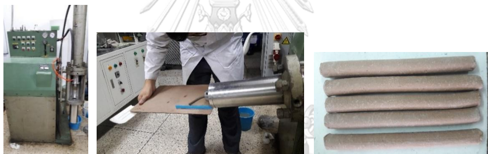
รูปที่ 3.7 การขึ้นรูปชิ้นงานด้วยวิธีการอัดรีด
