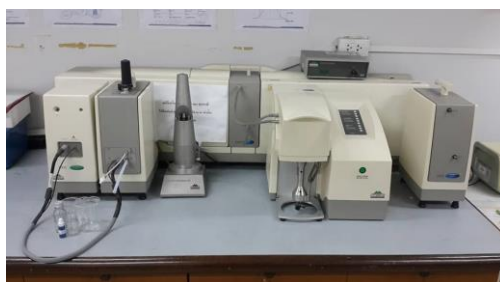
รูปที่ 3.11 เครื่อง Particle Size Analyzer ยี่ห้อ Malvern รุ่น Mastersizer 2000
