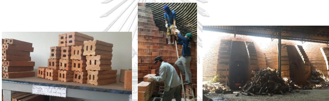
รูปที่ 2.10 อิฐดินเผาก่อสร้างจังหวัดอ่างทองและภาพเตาเผาทรงโดม
