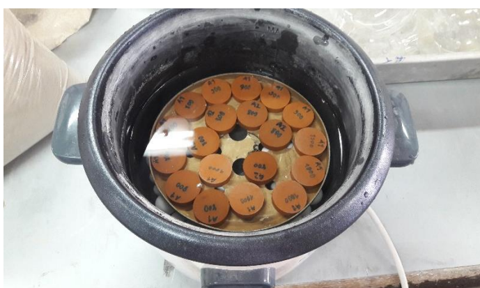
รูปที่.3.15 การแช่ชิ้นงานเพื่อวัดการดูดซึมน้ำ
