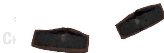
รูปที่ 4.22 ชิ้นงานดินเหนียวราชบุรีผสมเถ้าลอย 20 wt% เผาที่อุณหภูมิ 1200 °C เกิดแกนสีดำ
