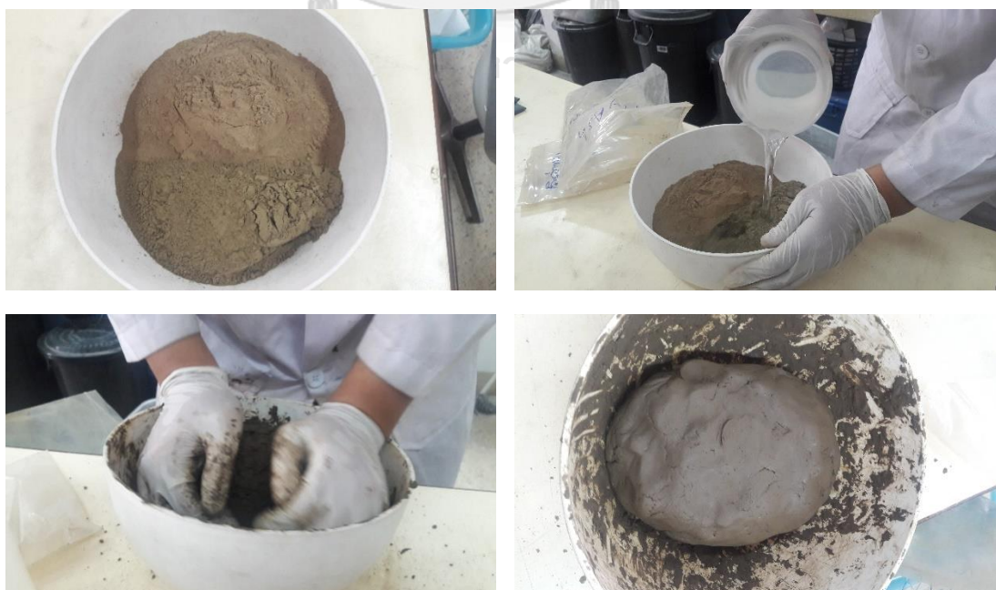
รูปที่ 3.5 การเตรียมก้อนดินผสม
