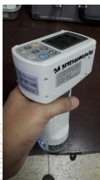
รูปที่ 3.16 เครื่อง Chroma meter ยี่ห้อ Konica Minolta รุ่น CR-400
