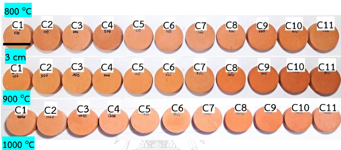
รูปที่ 4.38 ชี้นงานดินเหนียวชลบุรีหลังผ่านการเผาที่อุณหภูมิ 800, 900 และ 1000 °C
