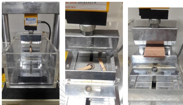
รูปที่ 3.17 เครื่อง Tensile / Compression Strength Tester ยี่ห้อ Hung Ta รุ่น HT-8116
