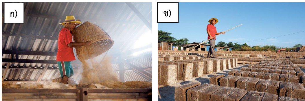
รูปที่ 2.9 ขั้นตอนการผลิตอิฐมอญ ก) การเผอิฐมอญด้วยแกลบ และ ข) การตากอิฐ [28]
