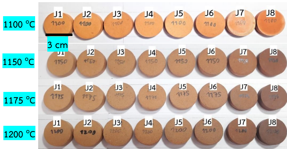
รูปที่ 4.34 ชิ้นงานดินเหนียวจันทบุรีหลังผ่านการเผาที่อุณหภูมิ 1100, 1150, 1175 และ 1200 °C
