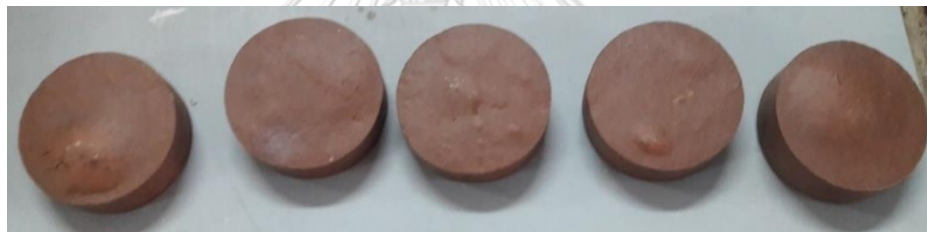
รูปที่ 4.21 ลักษณะชิ้นงานที่มีการฟองตัวที่ผิว
