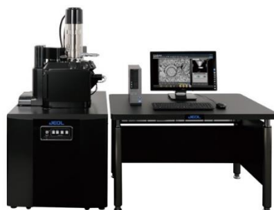
รูปที่ 3.11 กล้องจุลทรรศน์อิเล็กตรอนแบบส่องกราด [35]
