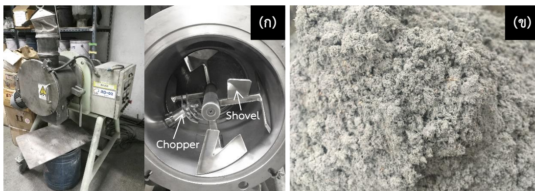
รูปที่ 3.1 (ก) เครื่องผสมวัสดุและลักษณะภายในเครื่อง และ (ข) วัสดุบดหลังการผสม
