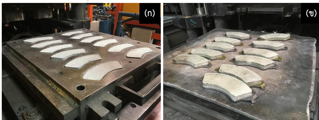
รูปที่ 3.3 (ก) ประกอบชิ้นงานหลังการอัดขึ้นรูปเย็นเข้ากับแผ่นเหล็ก และ (ข) ชิ้นงานหลังอัดขึ้นรูปร้อน
