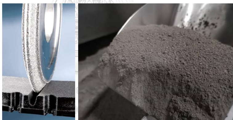
รูปที่ 2.14 (ก) ลักษณะล้อเจียรเพชร และ (ข) ลักษณะเศษฝุ่นที่นำกลับมาใช้
