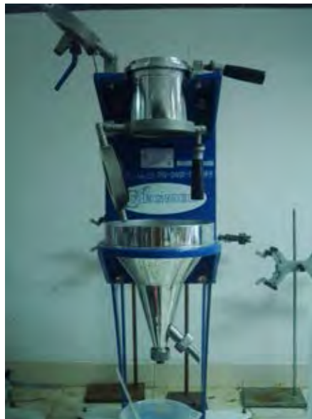
ภาพที่ 3-5 เครื่องวัดค่าสภาพระบายได้ (freeness tester)
