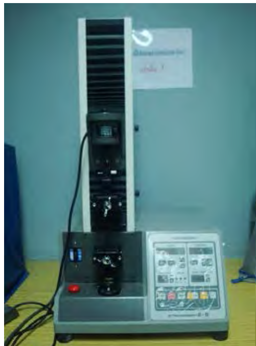
ภาพที่ 3-9 เครื่องวัดความแข็งแรงต่อแรงดึง (tensile index)
