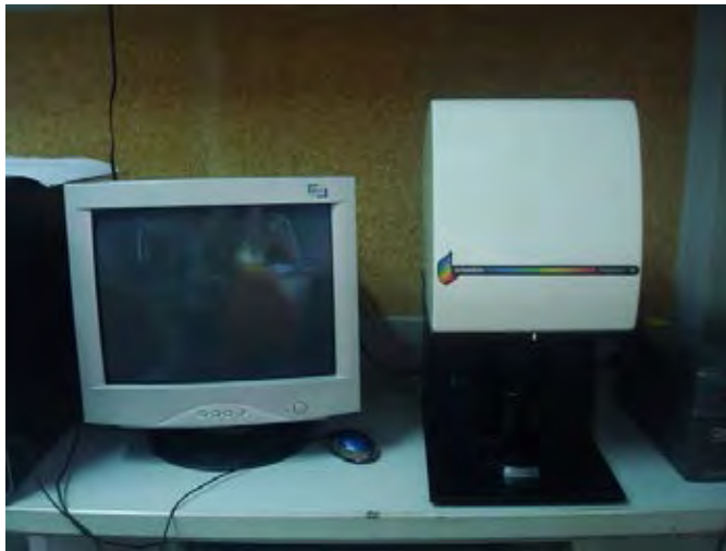
ภาพที่ 3-8 เครื่องวัดสมบัติเชิงแสง (Technidyne color touch PC)
