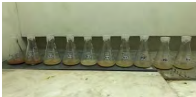
รูปที่ 3.7 การนำตัวอย่างมาทำให้อยู่ในรูปสารละลายด้วยกรดไนตริกผสมกับกรดซัลฟิวริก
