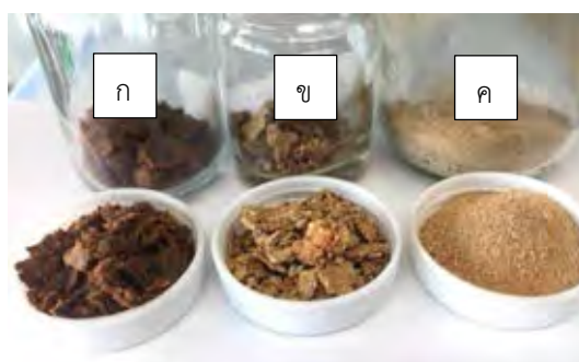
รูปที่ 4.1 ก) กากเมล็ดยางพาราหลังถูกบีบอัดด้วยเครื่องอัดสกรูเดี่ยว ข) กากเมล็ดยางพาราหลังการสกัดด้วยเครื่องซอกท์เลต ค) กากเมล็ดยางพาราหลังสกัดด้วยคาร์บอนไดออกไซด์ภาวะเหนือวิกฤต
