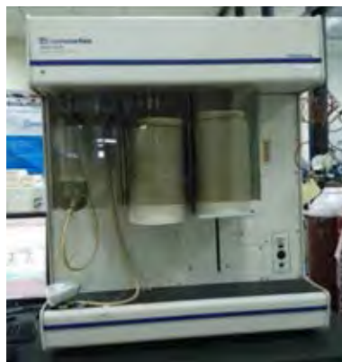
รูปที่ 3.3 เครื่อง Surface area and porosity analyzer ยี่ห้อ Micromeritics รุ่น ASAP 2020
