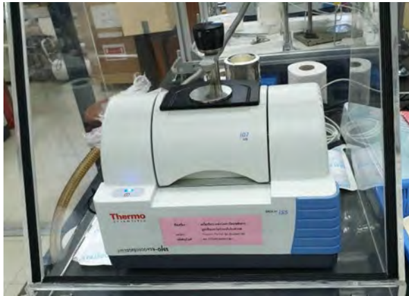
รูปที่ 3.5 เครื่อง Fourier transform infrared spectrometer ยี่ห้อ Thermo Fisher รุ่น Spectrum One
