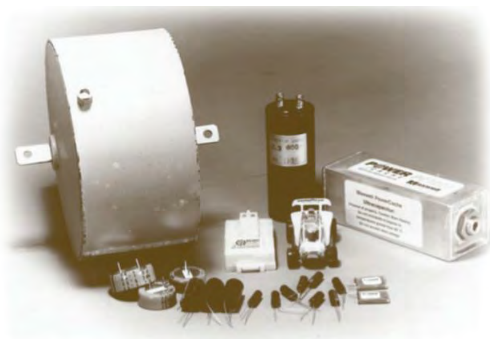
รูปที่ 2.3 ตัวเก็บประจุยิ่งยวดรูปทรงต่างๆ และของเล่นที่ใช้ตัวเก็บประจุยิ่งยวด [12]
