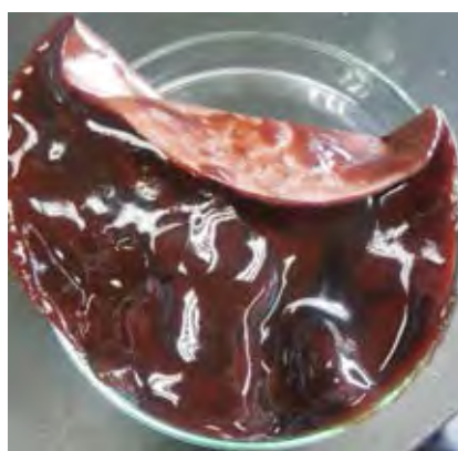
รูปที่ 4.15 แสดงตะกอนที่ได้หลังจากการตกตะกอนแบบที่ 2 ของกรดซัลฟิวริก 0.5 โมล/ลิตร อัตราส่วน 1:20 และเติมกรดแอสคอร์บิก ก่อนที่จะนำไปอบ
