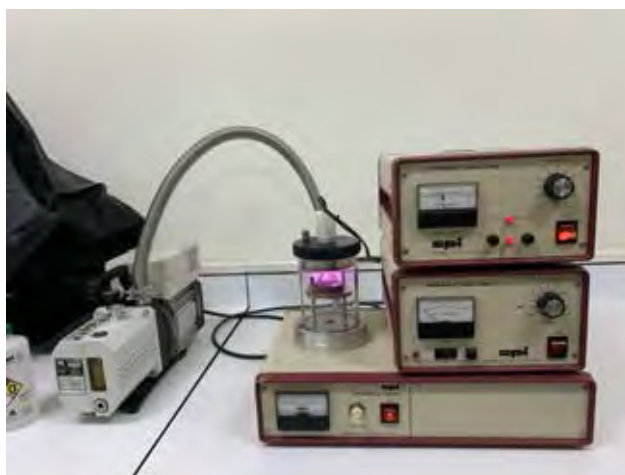
รูปที่ 3.16 เครื่องมือเคลือบทองบนตัวอย่างเพื่อนำไปตรวจ EDS
