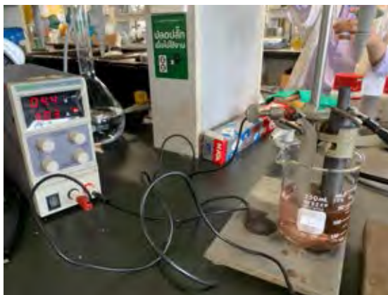
รูปที่ 3.15 การติดตั้งอุปกรณ์ในการใช้ไฟฟ้าเพื่อแยกแรงแกนีส
