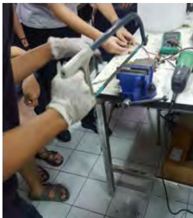
รูปที่ 3.1 การตัดแบตเตอรี่อัลคาไลน์เพื่อแยกส่วนของขั้วแคโทดออกมา
