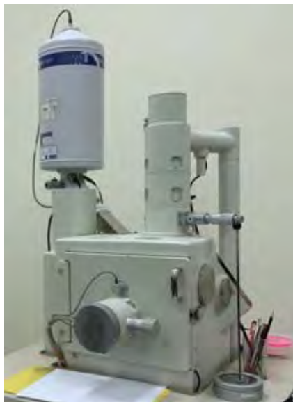
รูปที่ 3.17 กล้องจุลทรรศน์อิเล็กตรอน (Scanning electron microscope, SEM) และเครื่องวิเคราะห์หาธาตุด้าน X – Ray (Energy Dispersive X-ray Spectrometer, EDS หรือ EDX)
