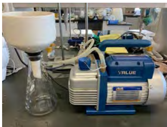
รูปที่ 3.7 ปั๊มสุญญากาศ (Vacuum pump)
