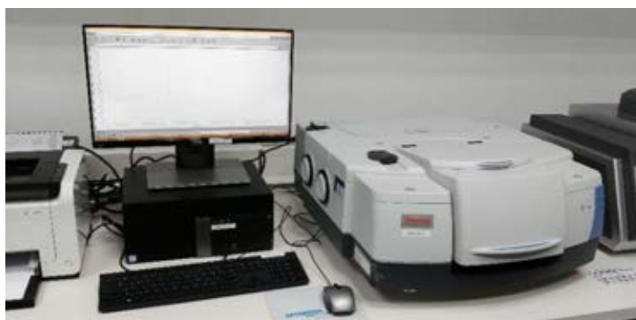
ภาพที่ 3.2.6 เครื่องมือ FTIR Spectrophotometer (Thermo Scientific Model: Nicolet iS50)
