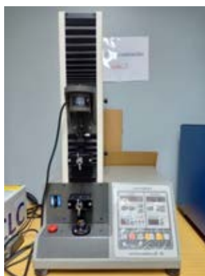
ภาพที่ 3.10 เครื่องวัดความแข็งแรงต่อแรงดึง
