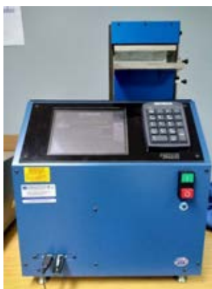
ภาพที่ 3.13 เครื่องวัดความต้านทานแรงกดวงแหวน
