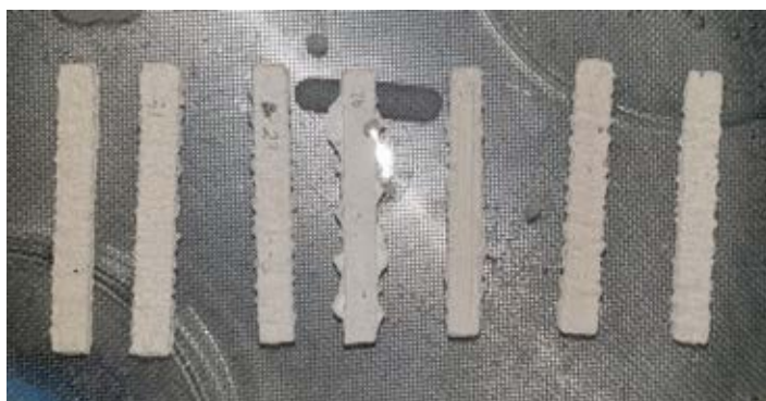
รูปที่ 26 ชิ้นงานที่กำลังทำการแช่น้ำที่อุณหภูมิ 60 องศาเซลเซียส เป็นเวลา 2.5 ชั่วโมง
