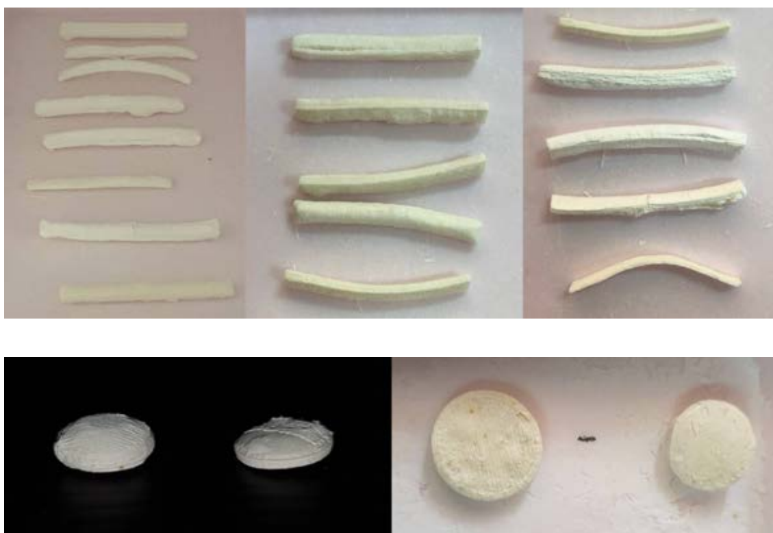
รูปที่ 24 ชิ้นงานหลังเผาที่ไม่ผ่านการแช่น้ำ
