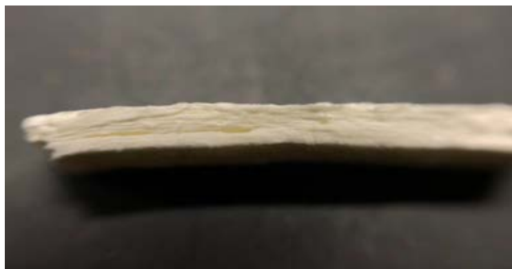
รูปที่ 27 ลักษณะการเกิดการแยกชั้นของชิ้นงาน
