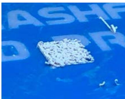
รูปที่ 22 Z13 ผสมแห้ง ชั้นล่างที่ออกมาแล้วแข็งตัว ไม่เชื่อมต่อกับชั้นบนที่ออกมาใหม่
