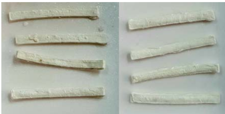
รูปที่ 25 ชิ้นงานหลังเผาที่ผ่านการแช่น้ำ
