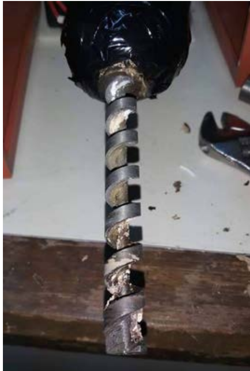
รูปที่ 29 สกรูภายในเครื่องรีดเส้นฟิลาเมนต์ที่เกิดการหลุดตัน
