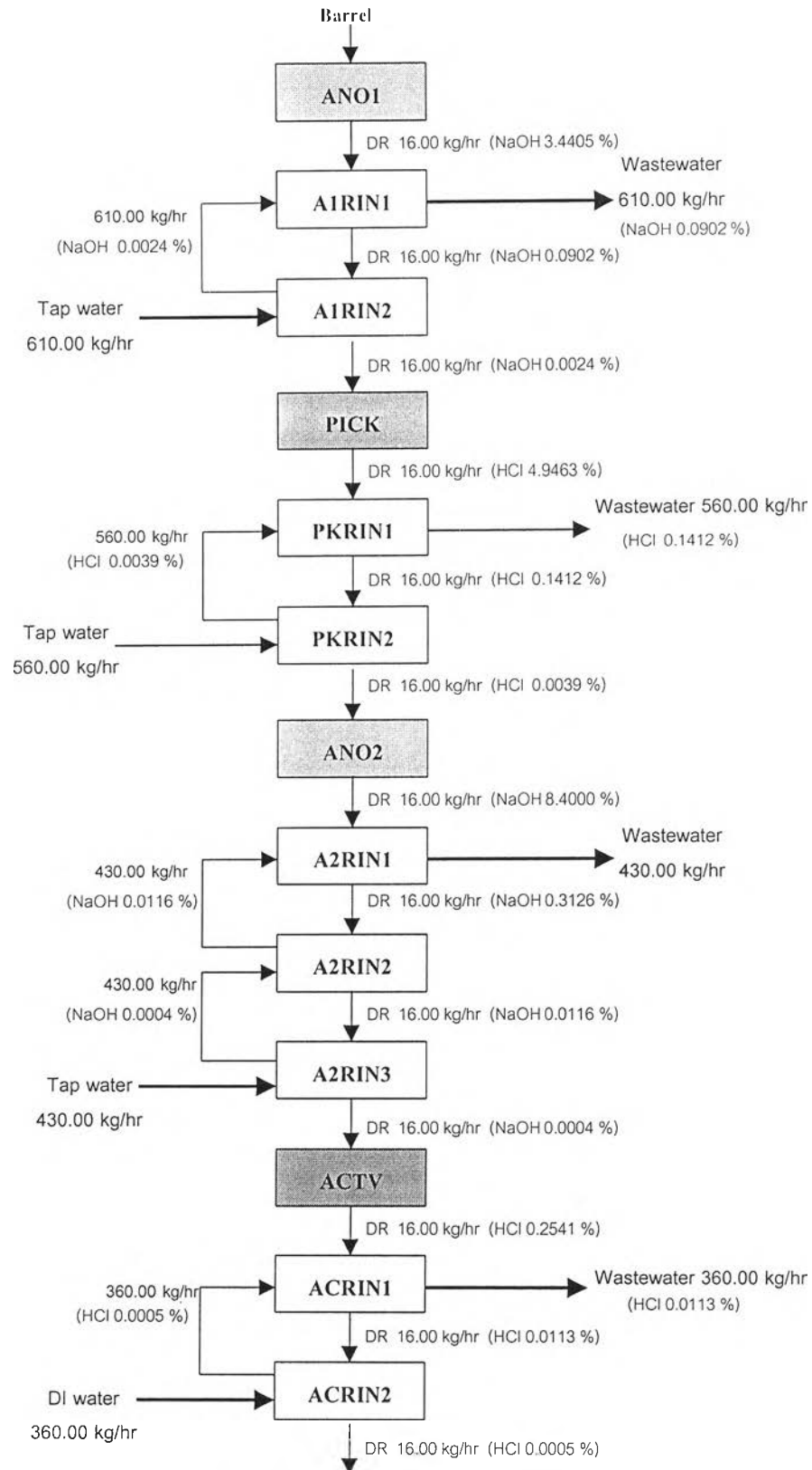
รูป 5.8 โฟลวชีทของกระบวนการเตรียมผิวชิ้นงานก่อนทำการปรับปรุง
