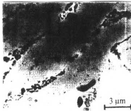
รูปที่ 2-8 อนุภาคสารประกอบเชิงโลหะ (Intermetallic Particle) ในอะลูมิเนียม AA8006 ภายหลัง Quenching จาก 510 องศาเซลเซียส
