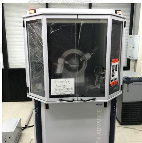
รูปที่ 3.7 เครื่องเอกซเรย์ดิฟแฟรคโทรมิเตอร์วิเคราะห์โครงสร้างผลึกและวัฏภาค
