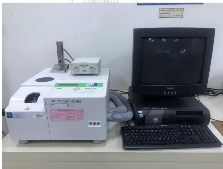
รูปที่ 3.6 เครื่องดิฟเฟอเรนเชียลสแกนนิ่งแคลอริมิเตอร์ differential scanning calorimeter (DSC)
