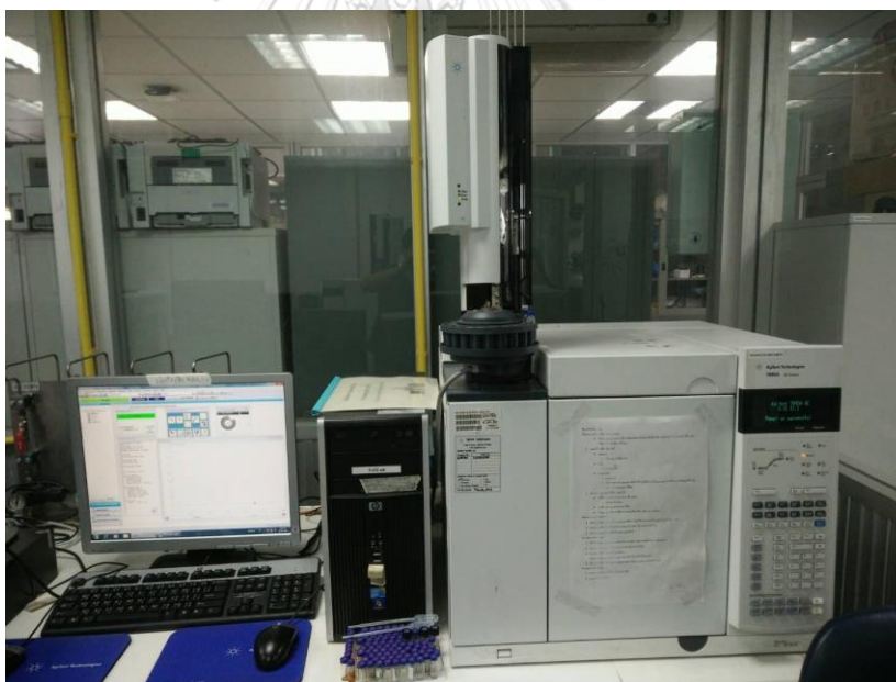
รูปที่ 3.4 เครื่องแก๊สโครมาโทกราฟีจำลองการกลั่น
