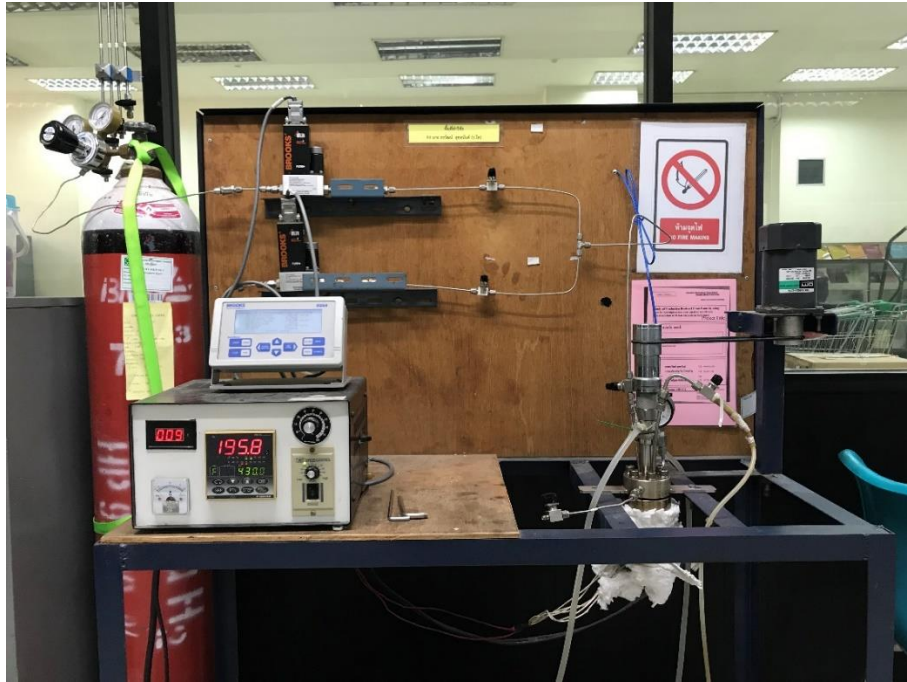
รูปที่ 3.2 เครื่องมือที่ใช้ทดสอบปฏิกิริยาดีออกซิเจเนชัน แครกกิง และ ไอโซเมอไรเซชัน
