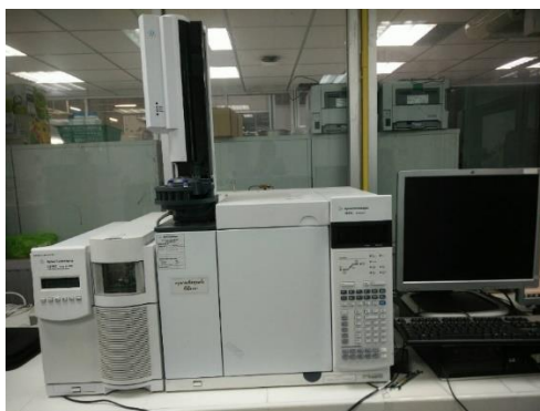
รูปที่ 3.5 เครื่องแก๊สโครมาโทกราฟีประกอบด้วยแมสสเปกโตรมิเตอร์
