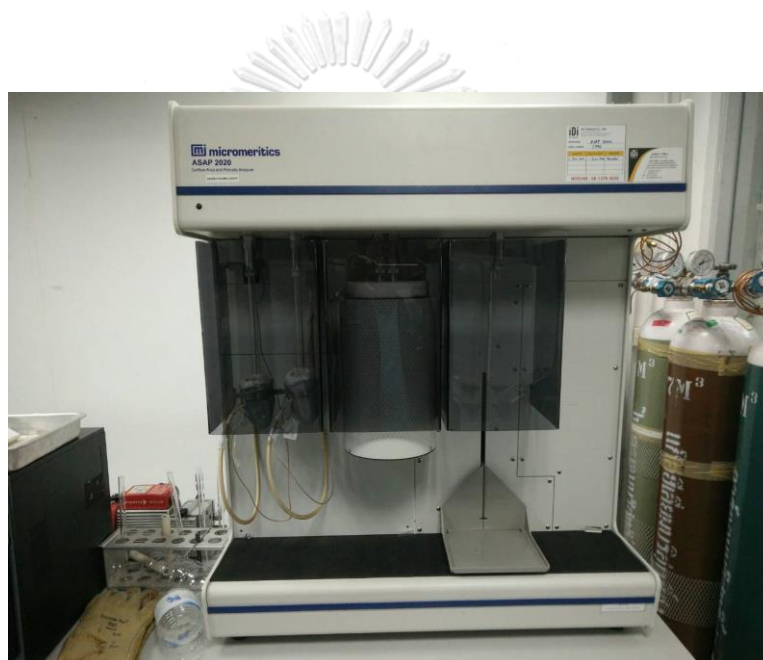
รูปที่ 3.8 เครื่องวิเคราะห์พื้นที่ผิวจำเพาะและรูพรุนของอนุภาคตัวเร่งปฏิกิริยาด้วยเทคนิคการดูดซับแก๊สไนโตรเจน
