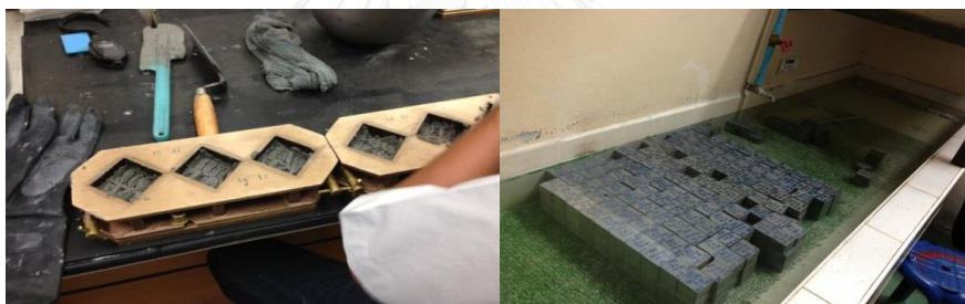
รูปที่ 10 แบบหล่อและอ่างบ่มใช้ทดสอบความต้านแรงอัดของมอร์ตาร์ปูนซีเมนต์ไฮดรอลิก
