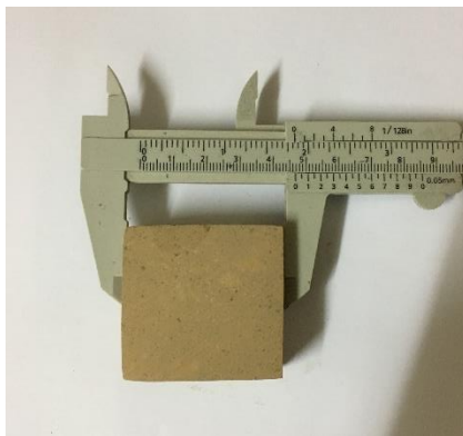
รูปที่ 3.7 การวัดขนาดของอิฐที่ผ่านการขึ้นรูปก่อนทำการเผาที่อุณหภูมิสูง
