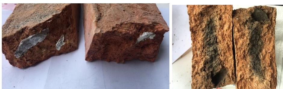
รูปที่ 2.2 การปนของเม็ดหินในอิฐกับการเผาอิฐโดยที่ความร้อนเข้าไปไม่ถึงข้างใน
