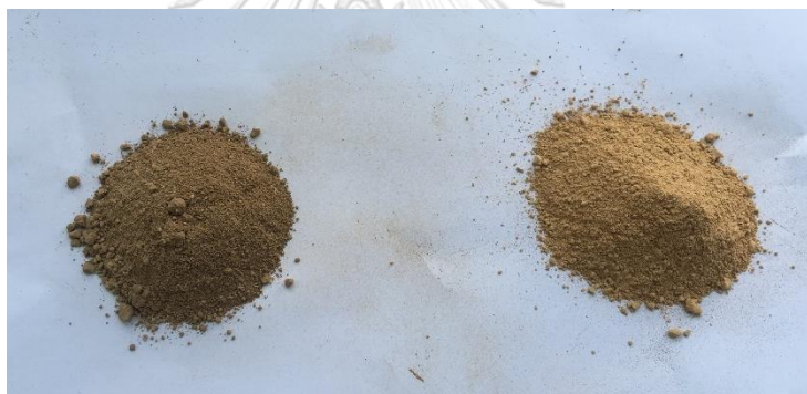
รูปที่ 3.4 การเตรียมตะกอนจากเหมืองและดินเหนียวที่สัดส่วนการผสมต่างกัน
