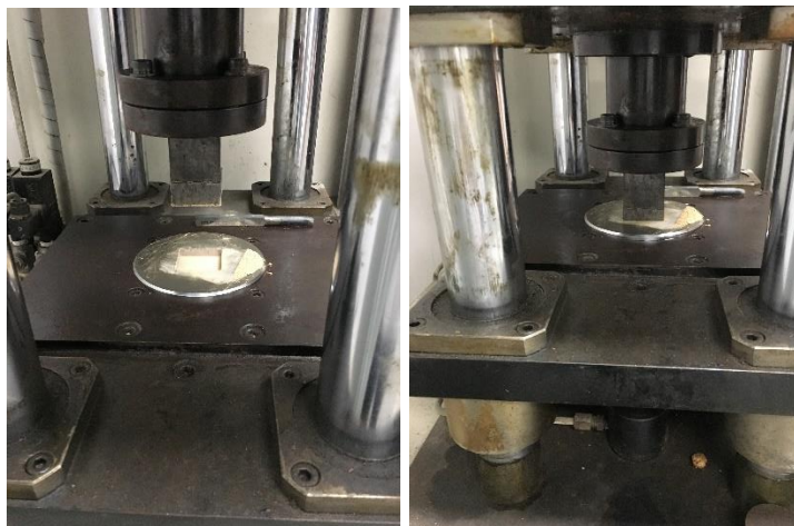
รูปที่ 3.5 การขึ้นรูปของดินตะกอนและดินเหนียวที่ผสมกันด้วยเครื่องอัดไฮดรอลิก ในขณะลงพิมพ์
