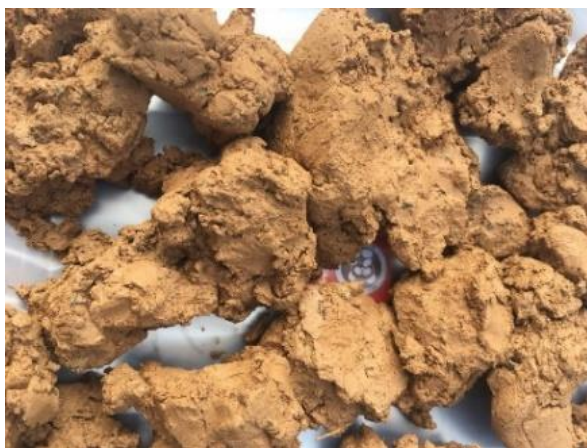
รูปที่ 1.7 ดินตะกอนที่ออกจากเครื่องแยกเมื่อความชื้นบางส่วนหายไป
