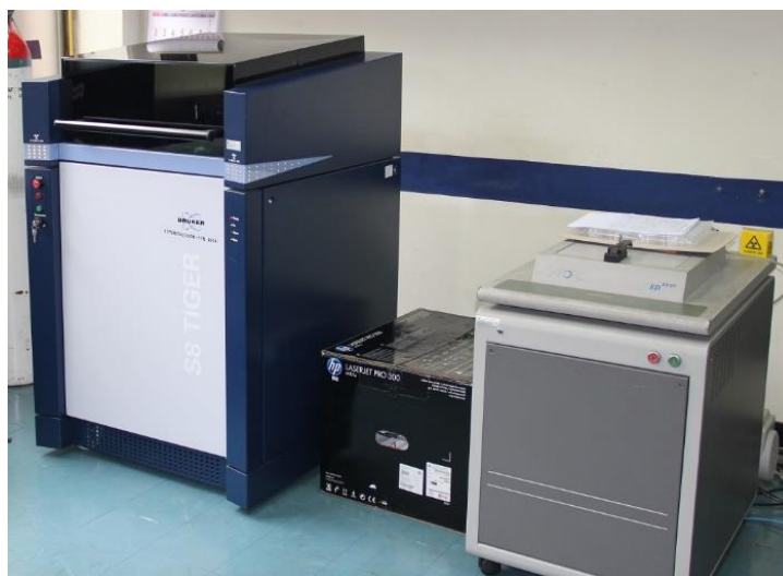
รูปที่ 1.10 เครื่องวิเคราะห์ธาตุด้วยเอกเรย์ฟลูออเรสเซนซ์
