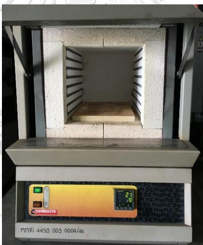
รูปที่ 3.8 เตาเผาที่ใช้เอาอิฐดินเผาที่ 900 -1100 องศาเซลเซียส
