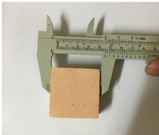
รูปที่ 3.9 การวัดขนาดของอิฐที่ผ่านการขึ้นรูปหลังทำการเผาที่อุณหภูมิสูง
