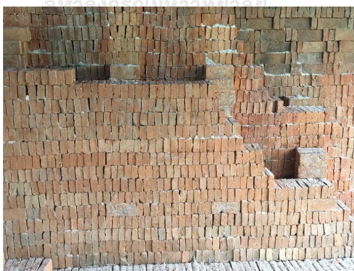
รูปที่ 2.1 การจัดเรียงอิฐที่จะเผาในระบบเปิดสู่บรรยากาศ
