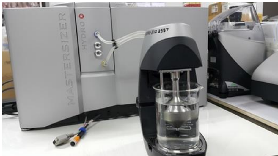
รูปที่ 1.11 เครื่องหาขนาดของอนุภาค (Laser particle size distribution analyzer)
