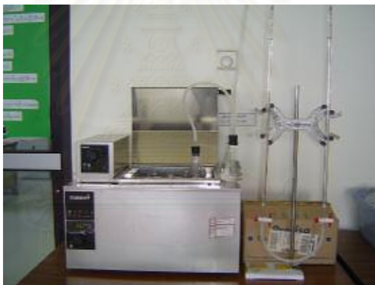
รูปที่ ง.1 อุปกรณ์ที่ใช้ในการหาค่าความสามารถจำเพาะของแบคทีเรียสร้างมีเทน (Specific Methanogenic Activity; SMA)
