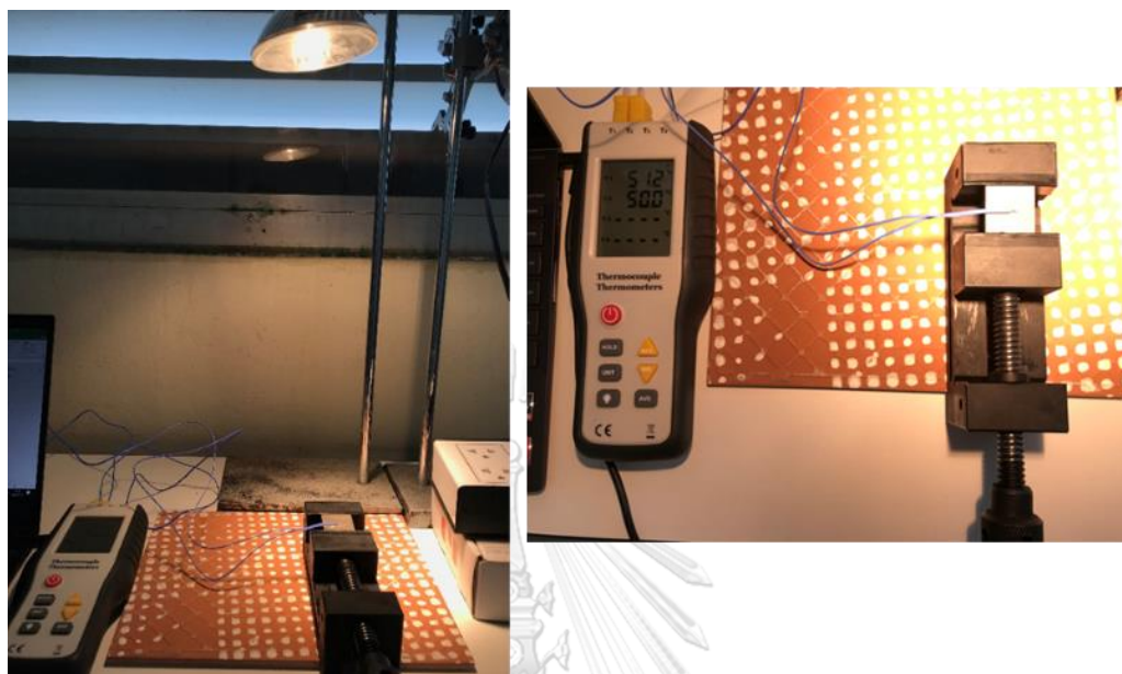
รูปที่ 45 แสดงวิธีการทดลองเพื่อคำนวณหาค่าการนำความร้อน (Thermal conductivity) ของฟิล์มอนุภาคนิกเกิล-อะลูมินา
