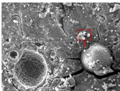
รูปที่ 44 ผลการทดสอบการวิเคราะห์ธาตุเชิงปริมาณของตัวอย่าง 0.5-NB0-6RHA ด้วยกำลังขยาย 1,000 เท่า
