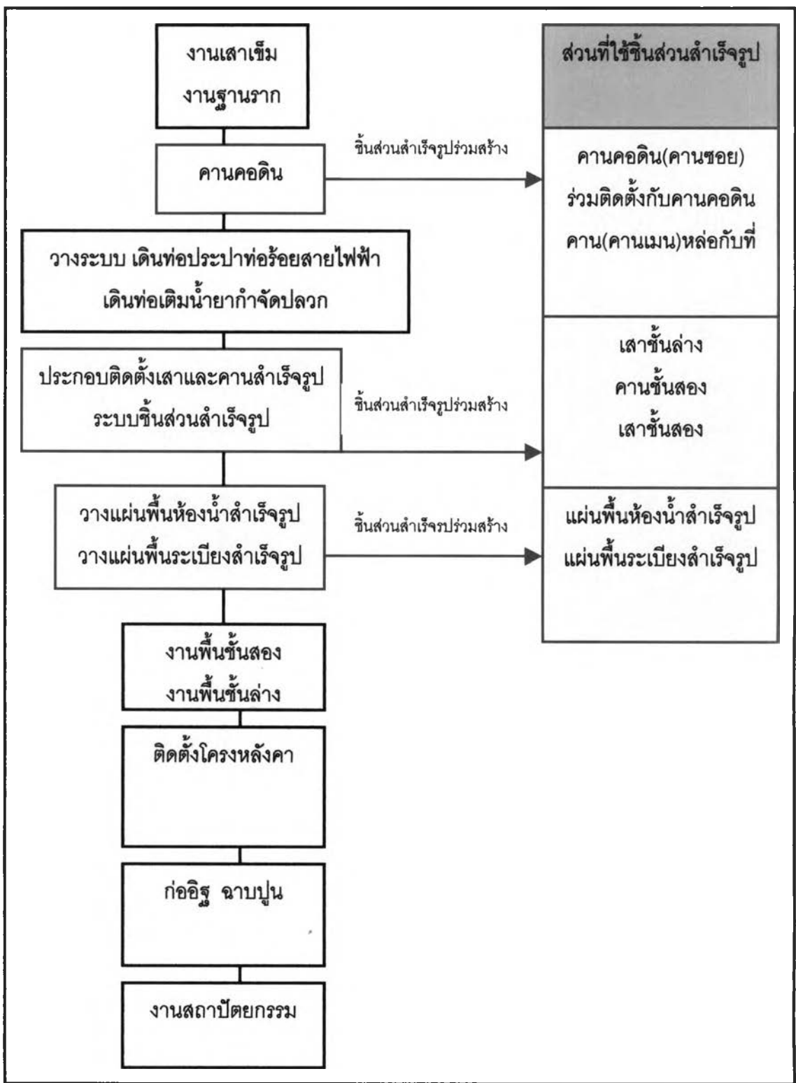
แผนภูมิที่ 6 – 3 ขั้นตอนการก่อสร้าง ที่นำชิ้นส่วนสำเร็จรูปมาร่วมใช้ในงานก่อสร้าง
