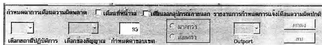
รูปที่ 4.8 หน้าต่างฟังก์ชันสำหรับการกำหนดการแจ้งความผิดพลาดของ RTU ของส่วนการประยุกต์การใช้งานบนไคลเอนท์
