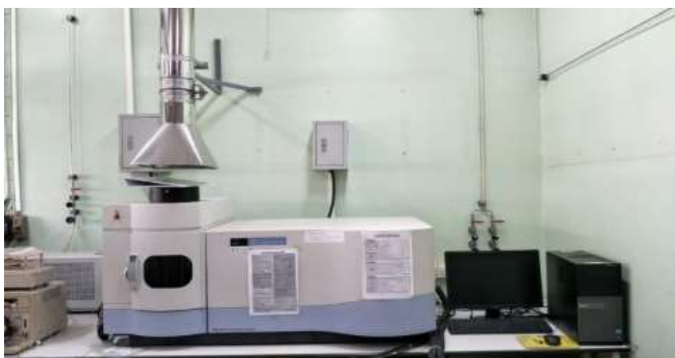
รูปที่ 3.7 เครื่องวิเคราะห์แร่ธาตุหลักจำเป็นในการทดลอง (ICP - OES, Optima 7300 DV, Perkin Elmer, England)
