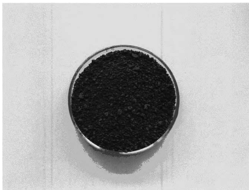
รูปที่ ก.4 ตัวอย่างตะกอนจากอุตสาหกรรมรีดเหล็กที่ผ่านการอบแห้ง
