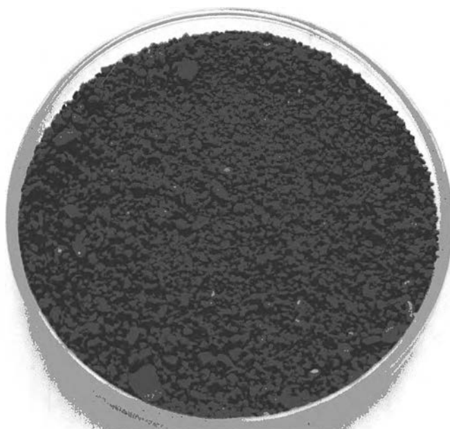
รูปที่ ก.2 ตัวอย่างตะกอนจากอุตสาหกรรมประกอบรถยนต์ที่ผ่านการอบแห้ง
