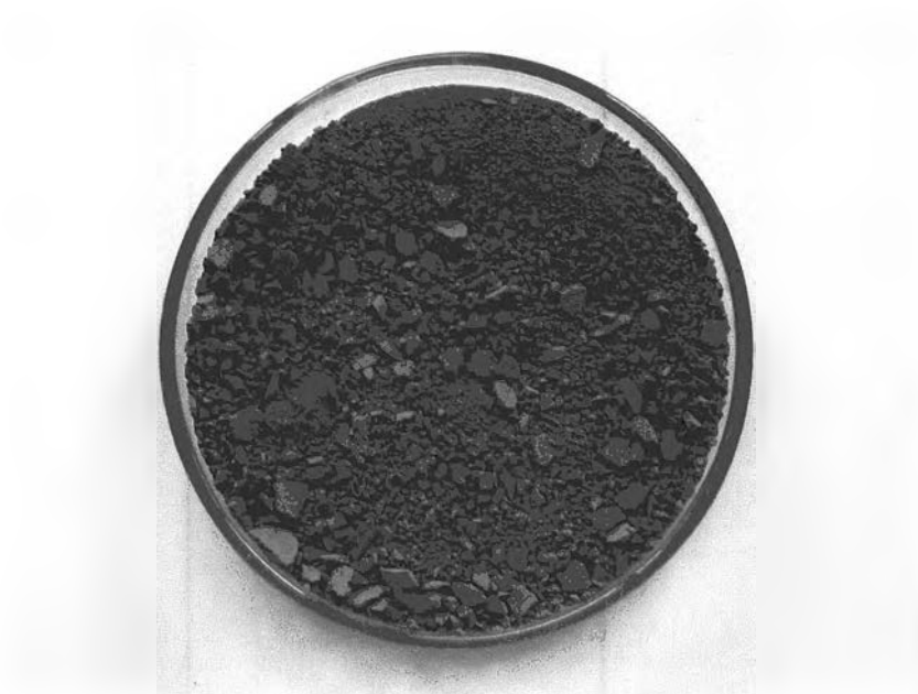
รูปที่ ก.5 ตัวอย่างตะกอนจากอุตสาหกรรมผลิตจอภาพที่ผ่านการอบแห้ง
