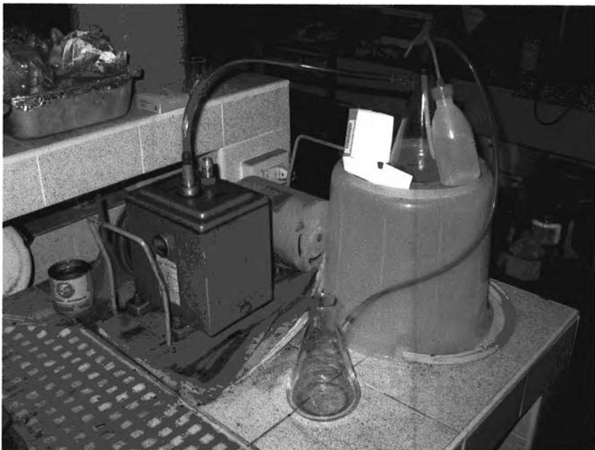
รูปที่ ข.4 เครื่องกรองที่ใช้ในการกรองสารละลายที่ผ่านการสกัดสารตามประกาศกระทรวง อุตสาหกรรมฉบับที่ 6 (พ.ศ. 2540)
