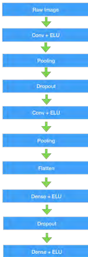
ภาพที่ 3.10 โครงสร้างของแบบจำลองจำแนกรูปภาพที่ผู้จัดทำสร้าง
