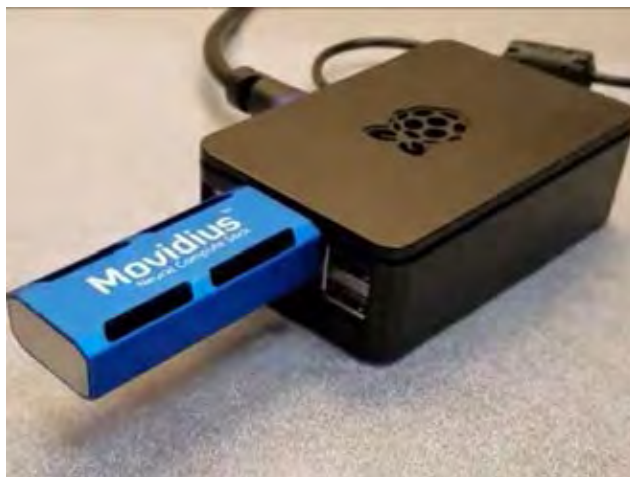
ภาพที่ 2.13 Intel movidius ที่เชื่อมต่อกับ Raspberry Pi
