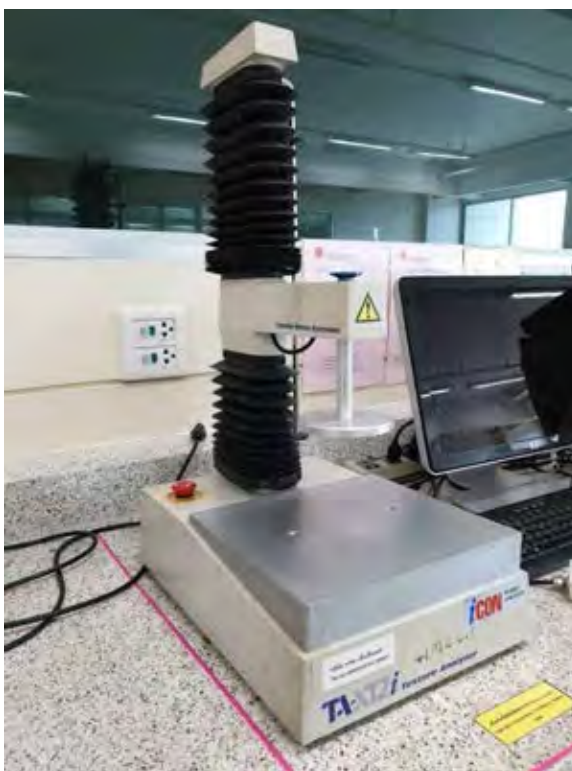
รูปที่ จ.5 เครื่อง Texture Analyzer ที่ใช้ในการทดลอง
