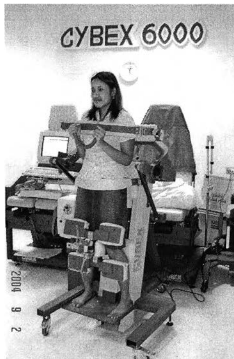
ภาพที่ 3.1 แสดงเครื่องออกกำลังกายแบบ Isokinetic รุ่น Cybex 6000
