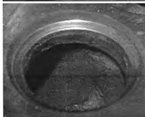
รูปที่ 6-67 แสดงภาพถ่ายบ่าวาล์วไอดีบนฝาสูบ จากเครื่องยนต์ที่ใช้น้ำมันดีเซล ร่วมกับก๊าซชีวภาพ
