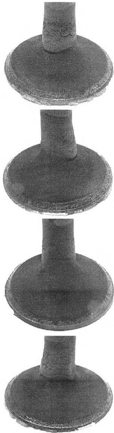
รูปที่ 6-73 แสดงภาพถ่ายวาล์วไอเสียจาก เครื่องยนต์ที่ใช้น้ำมันดีเซลร่วมกับ ก๊าซชีวภาพ
