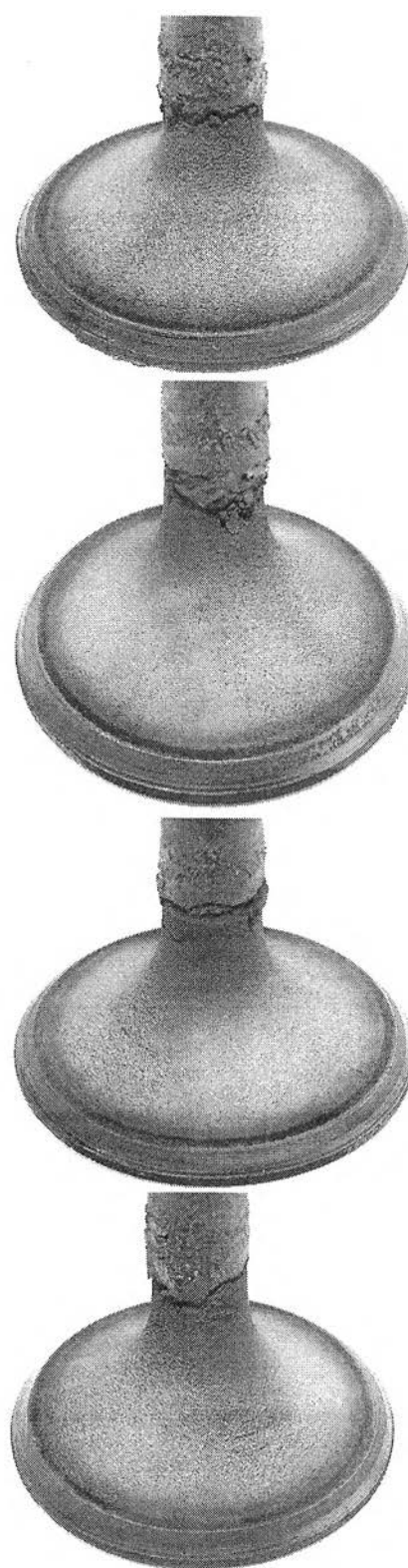
รูปที่ 6-71 แสดงภาพถ่ายวาล์วไอดีบนฝาสูบ จากเครื่องยนต์ที่ใช้น้ำมันดีเซล ร่วมกับก๊าซชีวภาพ
