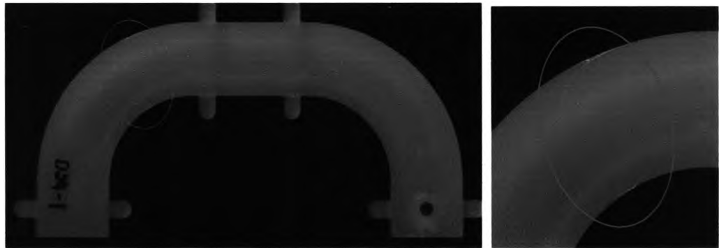
รูป 5.15 แสดงร่องรอยการไหลของพลาสติกหลอม
