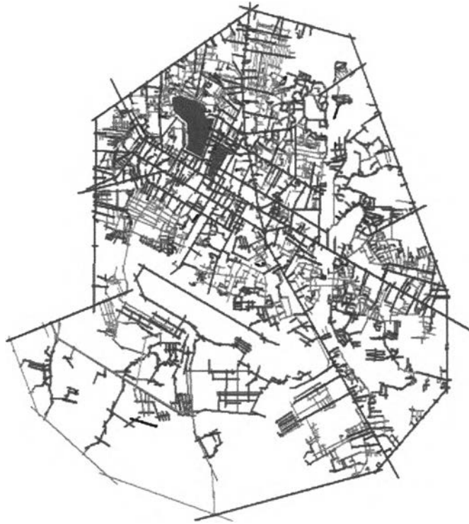
รูปที่ 2.10 การวิเคราะห์ศักยภาพในการเข้าถึงระดับพื้นที่รวม (global integration analysis) ของเส้นทางต่าง ๆ ในโครงข่ายการสัญจร (spatial grid network) ของเมืองอุดรธานีด้วยโปรแกรม Space Syntax (Paksukcharern, Kasemsook, and Suvanajata, 2003)
