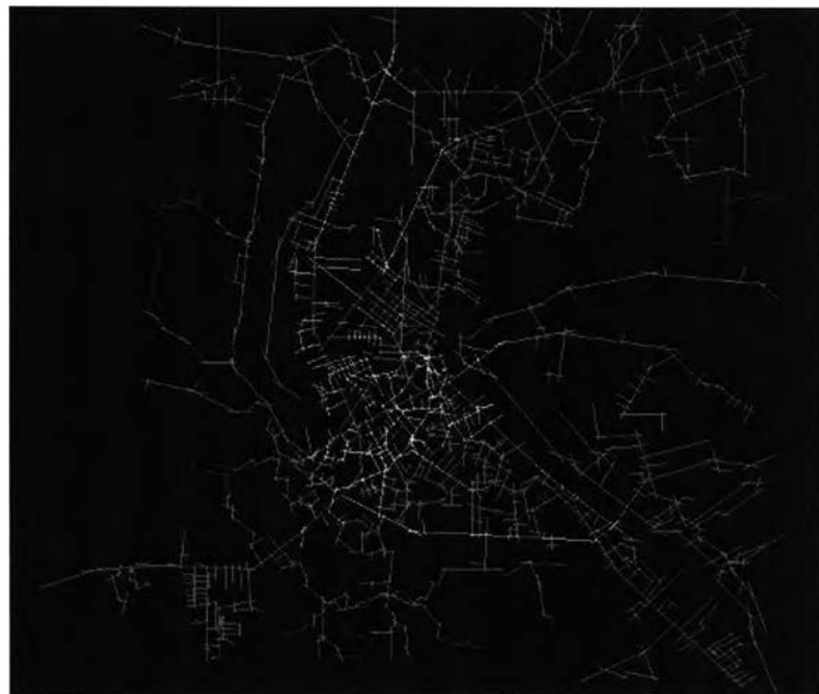
รูปที่ 2.11 การวิเคราะห์ศักยภาพในการเข้าถึงระดับพื้นที่รวม (global integration analysis) ของเส้นทางต่าง ๆ ในโครงข่ายการสัญจร (spatial grid network) ของเมืองอุทัยธานี ด้วยโปรแกรม Space Syntax (ไชศรี ภัคดีสุขเจริญ, 2546)
