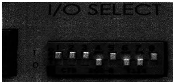
รูปที่ ข.6 ตำแหน่งของสวิตช์เลือกคุณสมบัติของชุดควบคุม
