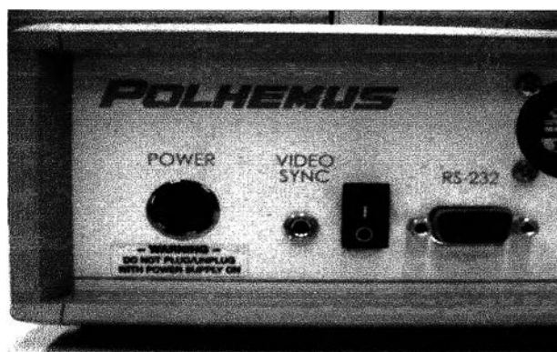
รูปที่ ข.7 ตำแหน่งของช่องต่อสัญญาณแบบ RS-232
