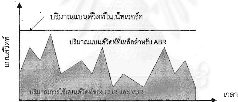
รูปที่ 1.6 ตัวอย่างปริมาณการใช้แบนด์วิดท์ของช่องสัญญาณข้อมูล CBR และ VBR
