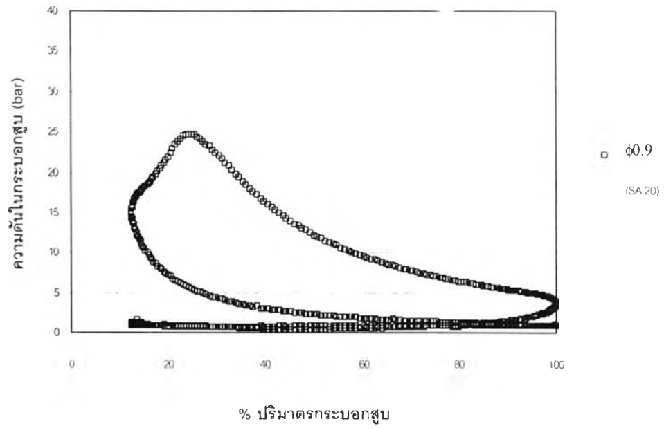
รูปที่ 4.7 (จ) แสดง P-V Diagram ที่ความเร็วรอบ 2100 rev./min. อัตราการไหลอากาศ 100% (WOT) เมื่อ equivalence ratio เป็น 0.9
