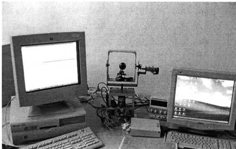
รูปที่ 4.10: การควบคุม camera gimbal โดยใช้ xPC target
