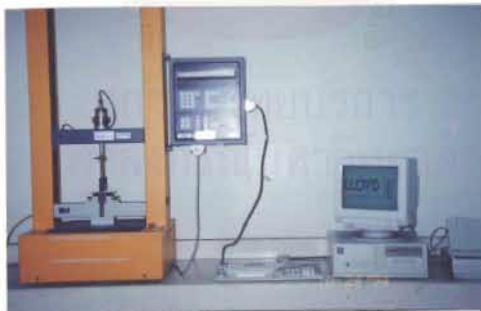
รูปที่ 3.4 เครื่องทดสอบ LLOYD 500
