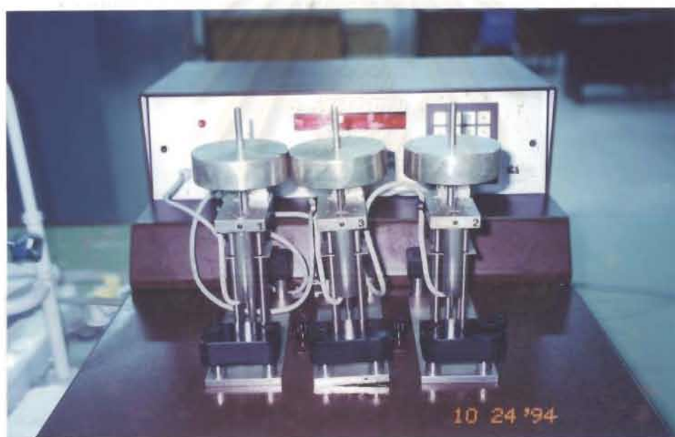
รูปที่ 3.3 เครื่องทดสอบหาจุดอ่อนตัวของพลาสติก (Vicat tester)
