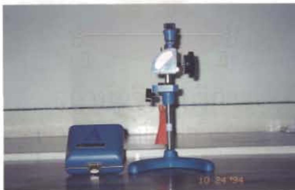
รูปที่ 3.2 เครื่องคูโรมิเตอร์ ชนิด Shore D
