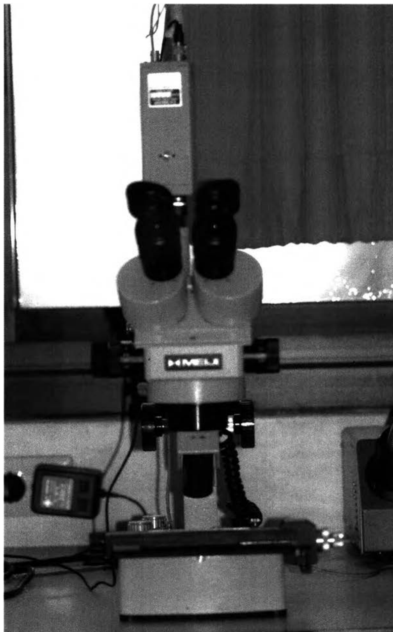
ภาพที่ 9 แสดงกล้องจุลทรรศน์ ชนิดสเตอริโอซึ่งใช้ตรวจดูลักษณะความล้มเหลวที่เกิดขึ้น
