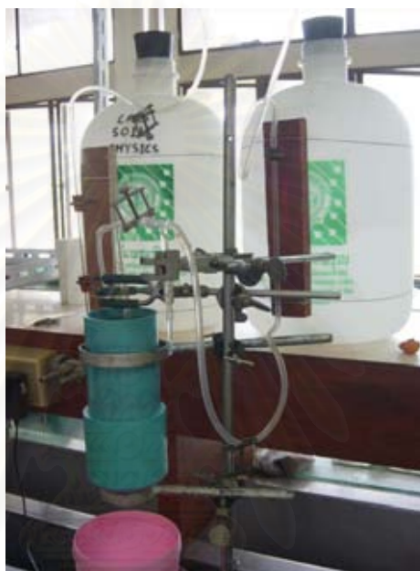
รูปที่ 4.6 การทดลองหาการเปลี่ยนแปลงความเข้มข้นของสารละลายโซเดียมที่เวลาต่างๆ
