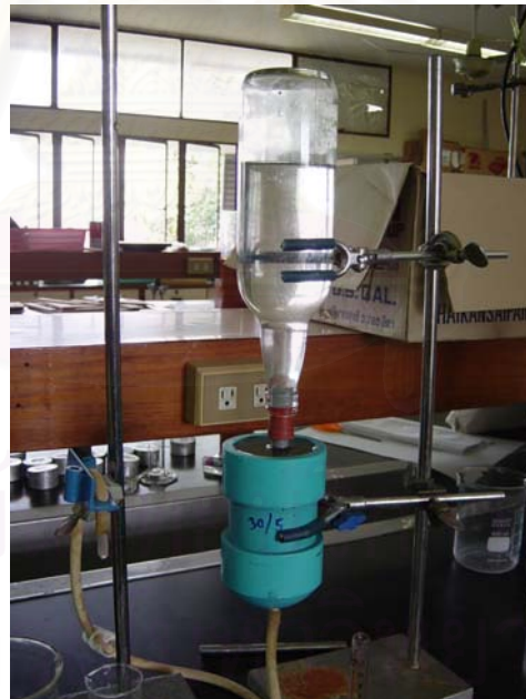
รูปที่ 4.2 การวัดสภาพการนำน้ำของดินโดยใช้วิธี Constant head
