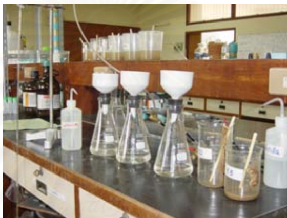
รูปที่ 4.5 การทดลองเพื่อวิเคราะห์หาปริมาณ โขเดียมในดิน
