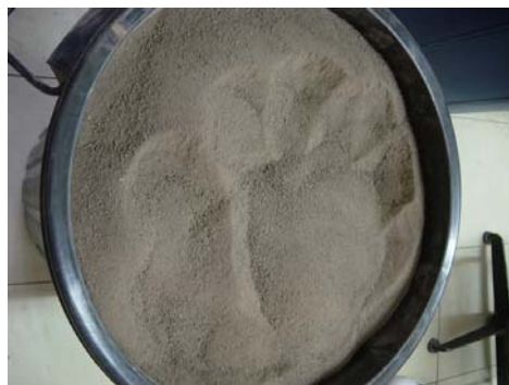
รูปที่ 4.4 ดินที่ผ่านการร่อนโดยตะแกรง 2.0 มม.
