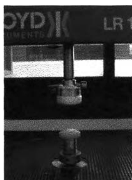
รูปที่ 2.4 การติดตั้งแป้นทดสอบบนเครื่องลอยดี
