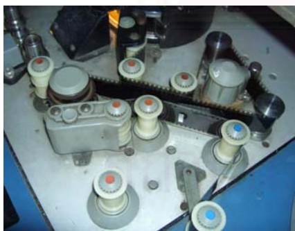
เครื่อง Steenbeck และการมาร์กตำแหน่งหมายเลขลงบนฟิล์ม
