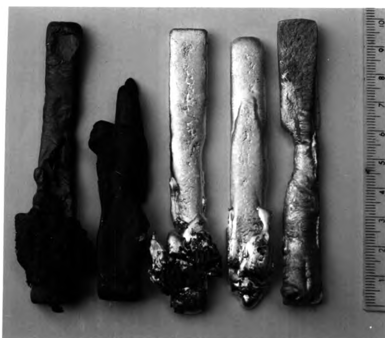
รูปที่ 4.14 (ง) ชิ้นงานล่อเงินสเตอร์ลิงที่เคลือบเคลือบซีเมนต์ซีเมนต์ 0.1, 0.2, 0.5, 0.75 และ 1.0 % เวลา 6 นาที เรียงจากด้านซ้ายมือมายังขวามือ
