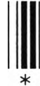
ภาพที่ 2.5 บาร์โค้ดแบบ 39 ของตัวอักษร “*” (ดอกจัน)
