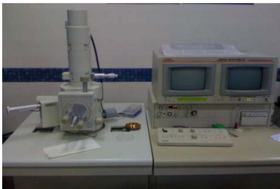
ภาพที่ 3.15 กล้องจุลทรรศน์อิเล็กตรอนแบบส่องกราด
