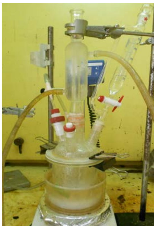
ภาพที่ 3.2 เครื่องปฏิกรณ์ที่ใช้สังเคราะห์นาโนเลเท็กซ์ของพอลิเมทิลเมทาคริเลต
