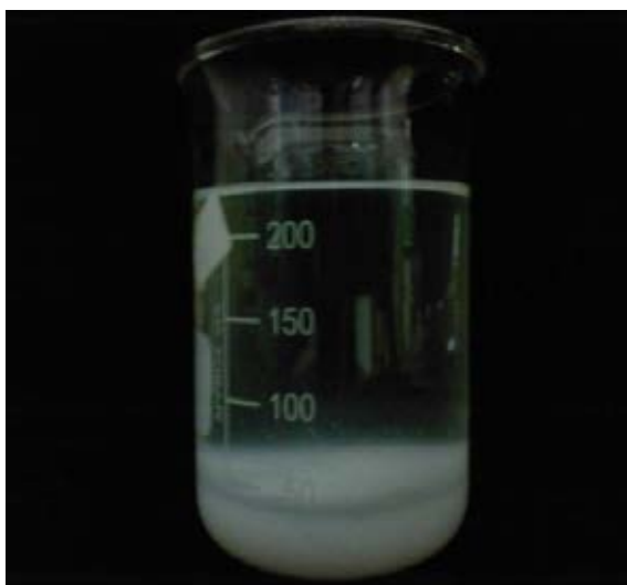
ภาพที่ 3.3 การตกตะกอนพอลิเมทิลเมทาคริเลตด้วยเมทานอลที่มากเกินไป
