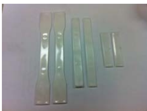
ภาพ ก-6 ชิ้นงานพอลิโพรพิลีน/เอทิลีนออกทีนโคพอลิเมอร์ ที่ได้จากการขึ้นภาพด้วยเครื่องฉีดแบบ
