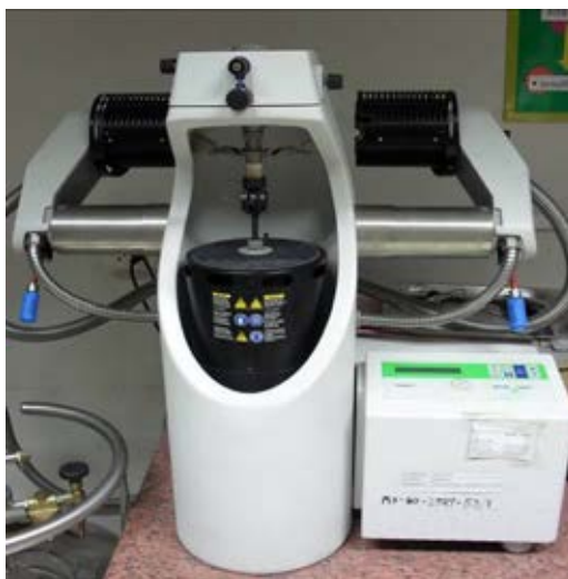
ภาพที่ 3.10 เครื่องวิเคราะห์สมบัติเชิงกลพลวัต (Mettler Toledo, DMA 861°)
