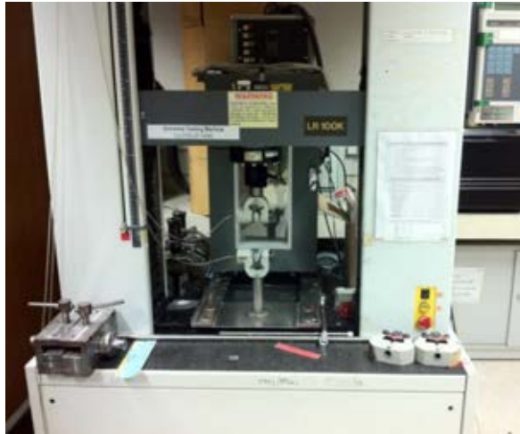
ภาพที่ 3.5 เครื่องทดสอบยูนิเวอร์แซล (LLOYD LR 100K)
