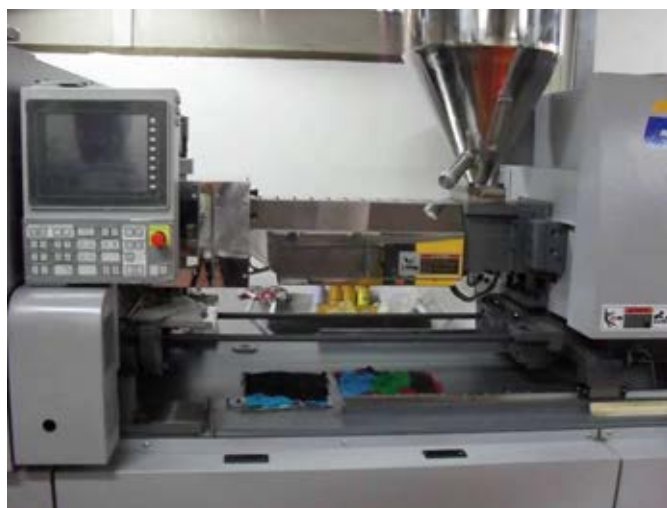
ภาพที่ 3.3 เครื่องฉีดแบบ (Toshiba machine EC 130S)
