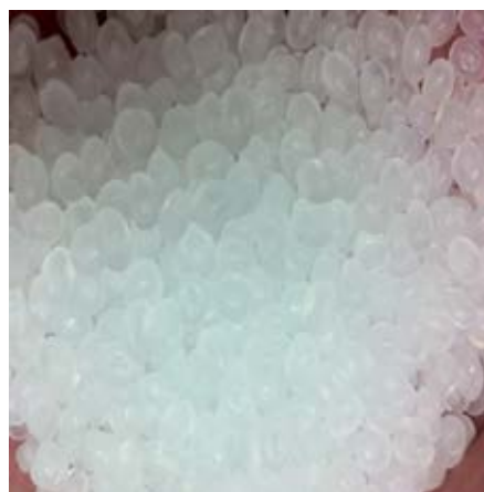
ภาพ ก- 2 เอทิลีนออกทีนโคพอลิเมอร์ (Engage™ 8200)
