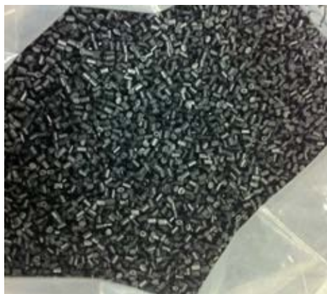
ภาพ ก-5 พอลิโพรพิลีน/เอทิลีนออกทีน โคพอลิเมอร์/คาร์บอนนาโนทิวบ์ ที่เตรียมได้จากเครื่องอัดรีดแบบเกลียวคู่
