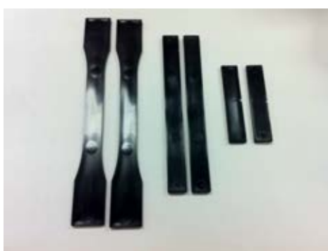
ภาพ ก-7 ชิ้นงานพอลิโพรพิลีน/เอทิลีนออกทีนโคพอลิเมอร์/คาร์บอนนาโนทิวบ์ ที่ได้จากการขึ้นภาพด้วยเครื่องฉีดแบบ
